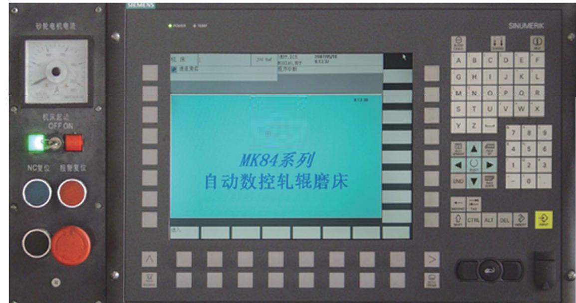
数控系统选用德国西门子840DSL数控系统。完成人机对话、编程、参数输入、数控测量、补偿磨削、数据处理等功能；15” TFT 液晶彩色显示屏、具有故障诊断、打印功能；系统内部集成了功能强大的PLC (S7-300) 完成实时在线控制及机床逻辑控制。
