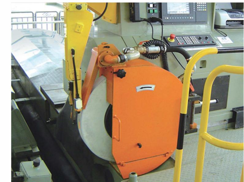
磨架横进给采用贴塑闭式静压导轨，滚珠丝杆传动，进给灵敏度高，抗震性好，运动平稳，导轨无磨损。
