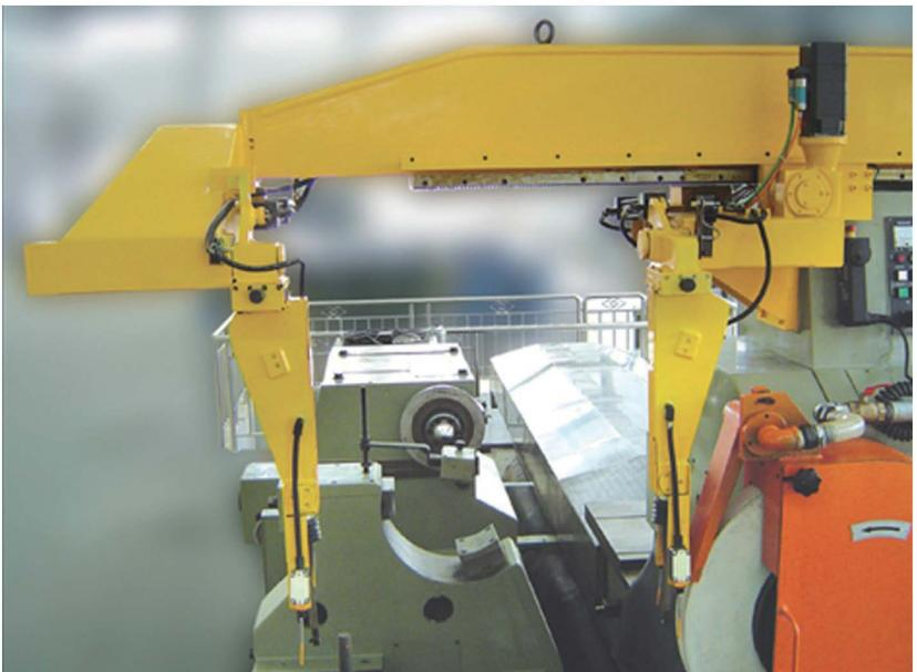
机床配有“CP”型自动工件检测系统，可在线和非在线对工件进行多种测量。可用于测量工件的直径，圆度，同轴度、同柱度，辊型曲线等。全部的测量结果可在屏移上观察及打印。
