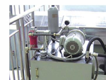
该系统由主轴液压系统和拖板液压系统组成，主要液压泵阀选用德国力士乐公司产品。主轴液压系统供油给砂轮主轴，采用油温控制箱控制油温在 $20^{\circ}\text{C} \pm 2^{\circ}\text{C}$ 范围内，使动静压轴承更可靠。拖板液压系统控制拖板的浮起量。
