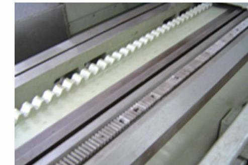
工件床身和砂轮床身为分体式床身，为大型机床床身的隔振设计，避免了工件床身和砂轮床身独立震源之间的相互影响。
